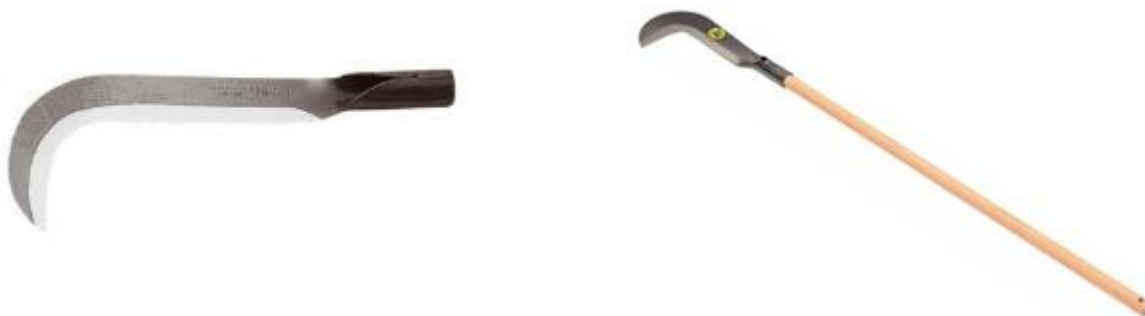
Figura 6-LXV: Exemplos de ferramentas utilizadas no serviço de roçada (foice roçadeira e foice gavião)
